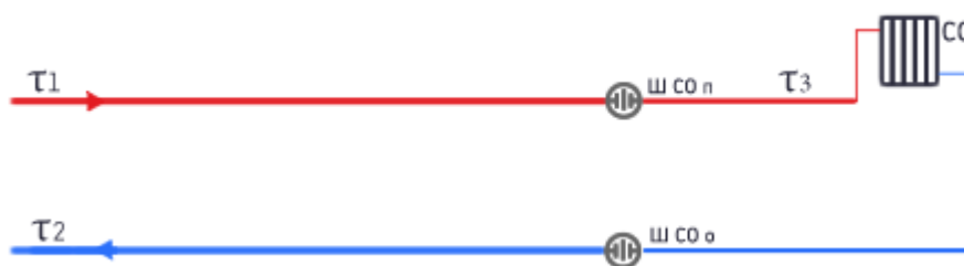
Рисунок 3 - Схема подключения потребителей к двухтрубной тепловой сети (при наличии внутридомовой системы отопления), зависимое присоединение, без смешения
